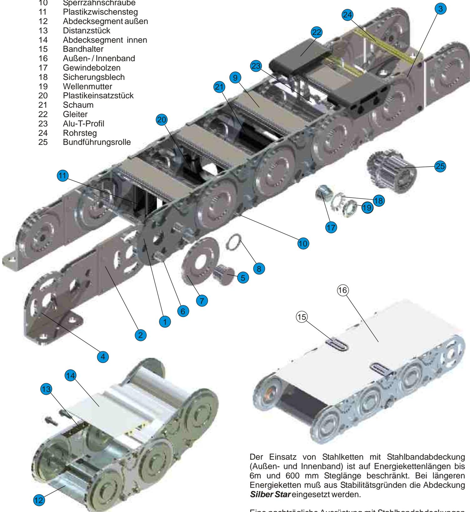
Der Einsatz von Stahlketten mit Stahlbandabdeckung (Außen- und Innenband) ist auf Energiekettenlängen bis 6m und 600 mm Steglänge beschränkt. Bei längeren Energieketten muß aus Stabilitätsgründen die Abdeckung **Silber Star** eingesetzt werden.
