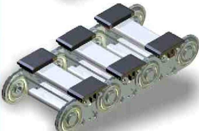
**SLE** Energieführungsketten zeichnen sich gegenüber Standardketten durch das stabile, stufenlos dem Bedarfsfall anzupassende Aluminiumprofil aus. Steglängen bis 1200 mm können realisiert werden. Die Aufteilung des Innenraumes läßt keine Wünsche offen und garantiert optimalen Kabelschutz selbst bei höchsten Beschleunigungen und Verfahrgeschwindigkeiten.
